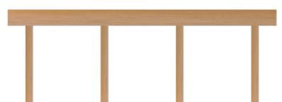
上：天板は既存建築の柱間4925mm、脚は畳の985mmに合わせて設計したテーブル。天板の両端は脚を失くして建築の柱で天板を支えることで浮遊感のある造形としている。
